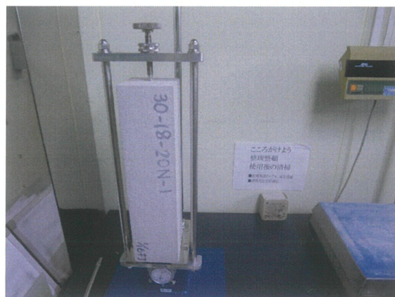
供試体長さの測定状況
